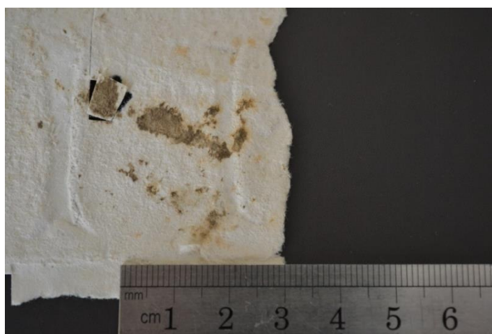
Рис. 4. Образец № 2. Темно-бурые пятна на поверхности листа
