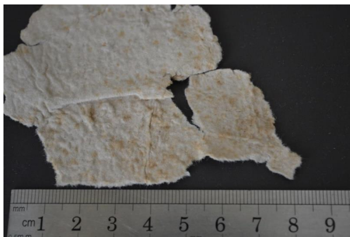
Рис. 5. Образец № 5. Фоксинги светло-бурого цвета звездчатой формы на поверхности листа
